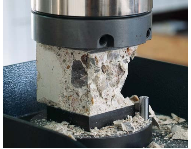
↑ Druckfestigkeitsprüfung bei einem Fließestrich.
