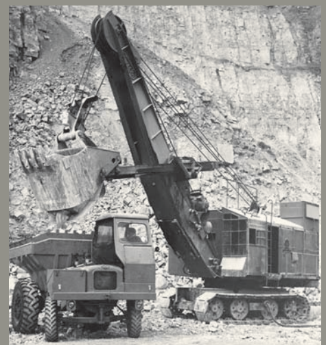
MENCK-BAGGER C250 und O&K HUBSCHAUFLER AS 600, 5.11.1955
