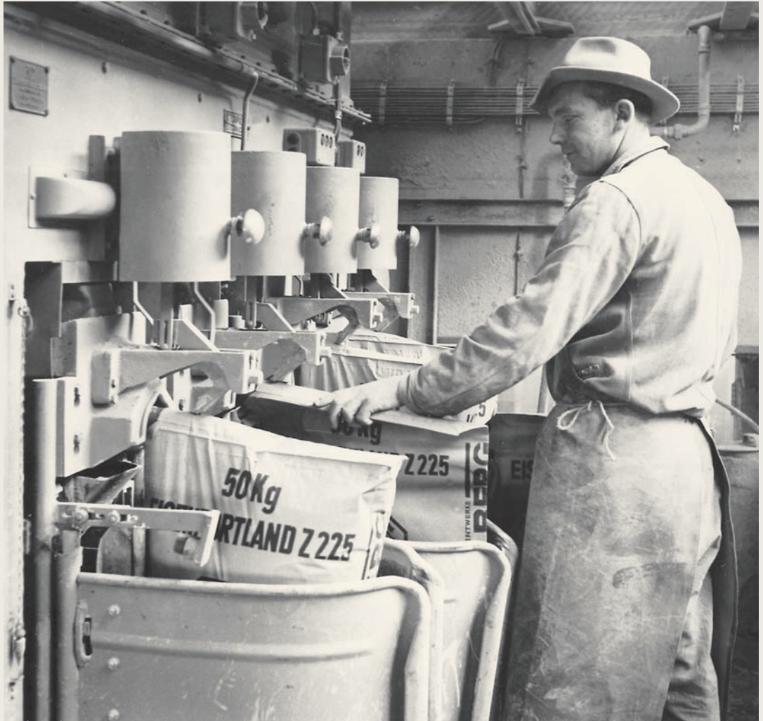
VIERSTUTZEN-PACKMASCHINE ab 21. Juni 1937 in Betrieb, 10.04.1956
