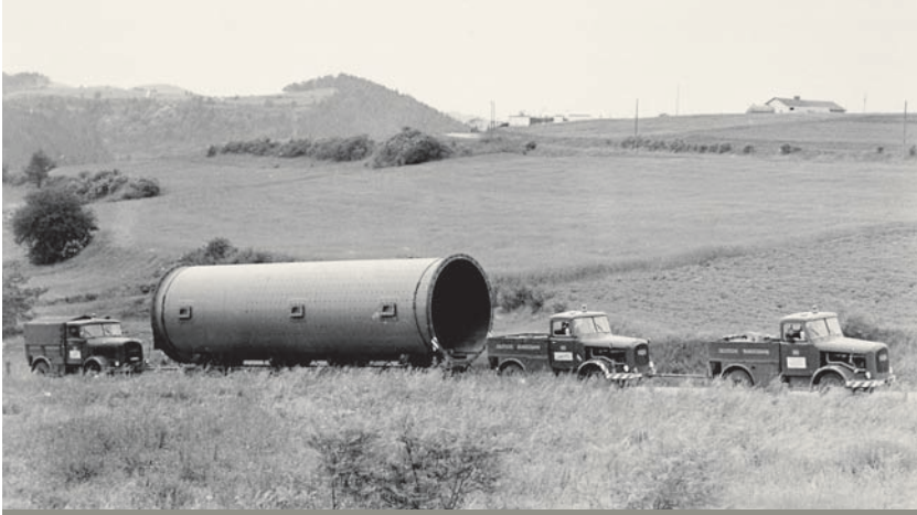
Transport eines ZEMENTMÜHLENROHRS mit drei Kaelble-Zugmaschinen, 1970
