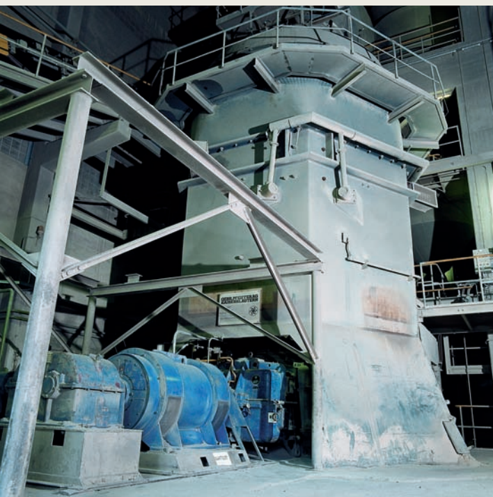
WALZENSCHÜSSELMÜHLE zur Mahlung des Kalksteins
