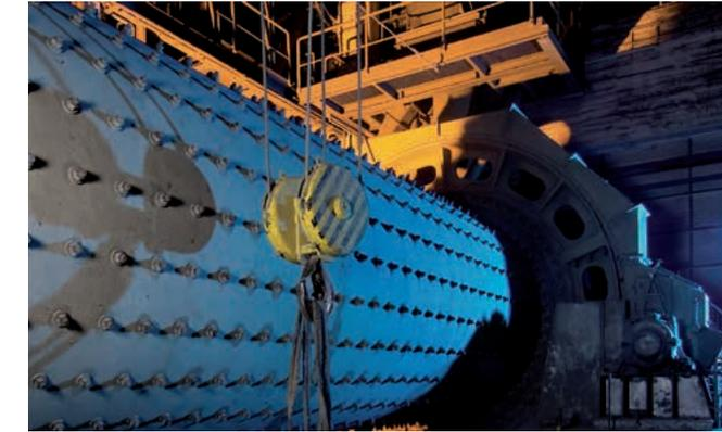
Die gewünschte Rohmischung aus Schotter und den je nach Anforderung an die Klinkerzusammensetzung erforderlichen Zuschlagstoffen, wie z.B. Quarzsand und Eisenerz, wird über Dosiereinrichtungen hergestellt. Walzenschüssel- und/oder Kugelmühlen vermahlen das Gemisch mehlfine und trocknen es gleichzeitig, bevor es zur weiteren Homogenisierung in die Rohmehlsilos gefördert wird.
