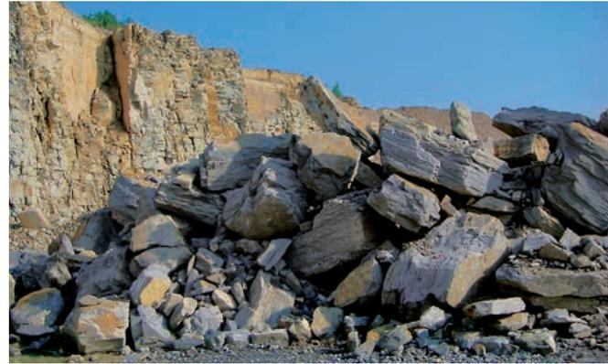
Die wichtigsten Rohstoffe für die Herstellung von Zement sind Kalkstein, Ton und Mergel. Sie werden in Steinbrüchen durch Sprengen oder mit schwerem Gerät durch Reißen gewonnen. Radlader und Muldenkipper transportieren die Rohmaterialien zu den Brecheranlagen. Dort wird das Gestein grob auf die Größe von Straßenschotter zerkleinert.
