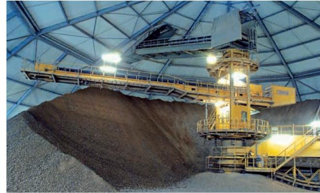
Dieses Material heißt Rohschotter und wird über Förderbänder, mit Seil- oder Schienenbahnen in die Schotterhalle transportiert, wo es im Mischbett eingelagert und homogenisiert wird.
